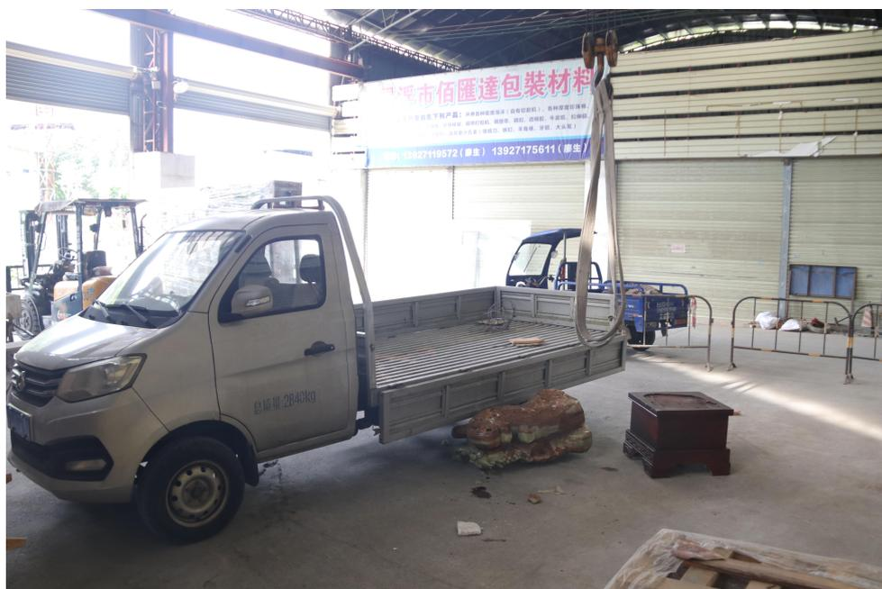
比车厢略高（车厢高度为 0.75 米），2 名工人用手扶住运行的吊物，吊物靠近车厢时突然掉落。黄某廷被掉落的石材工艺品砸中倒地受伤，造成头部开放性出血，经到场的 120 救护人员证实已经死亡。经法医鉴定其死因为颅脑胸腹部复合外伤。
